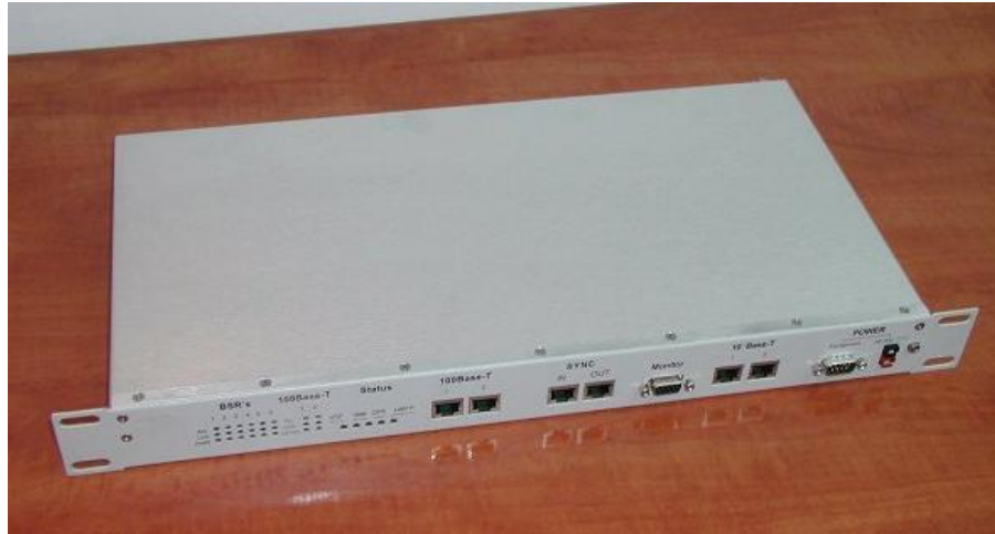
Figura 8 –Radio da Interno (IDU); da inserire nel telaio
